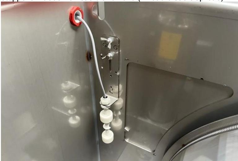
Le repère sur le support de la sonde en mode gravitaire doit être aligné sur le niveau d'eau à l'arrière du tambour avec une toile propre et la pompe bassin en fonctionnement pour cela vous devez suivre la procédure de réglages dans le menu Paramètre du coffret.
