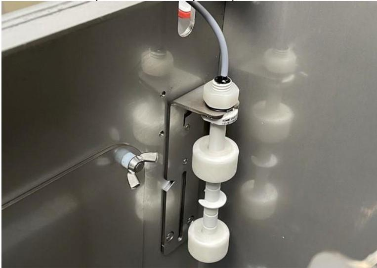
En mode **gravitaire**, la sonde est positionnée dans la chambre arrière du filtre, près du tambour.
