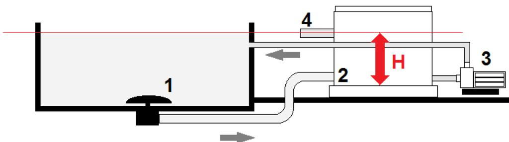
La bonde de fond (1) permet à l'eau de passer du bassin vers le filtre via la manchette d'alimentation (2). Les manchettes inutilisées sont obturées par des bonnets flexibles. L'eau filtrée quitte le filtre par l'arrière et est aspirée par la pompe (3) qui refoule vers le bassin (via la filtration biologique, non représentée sur le schéma).
